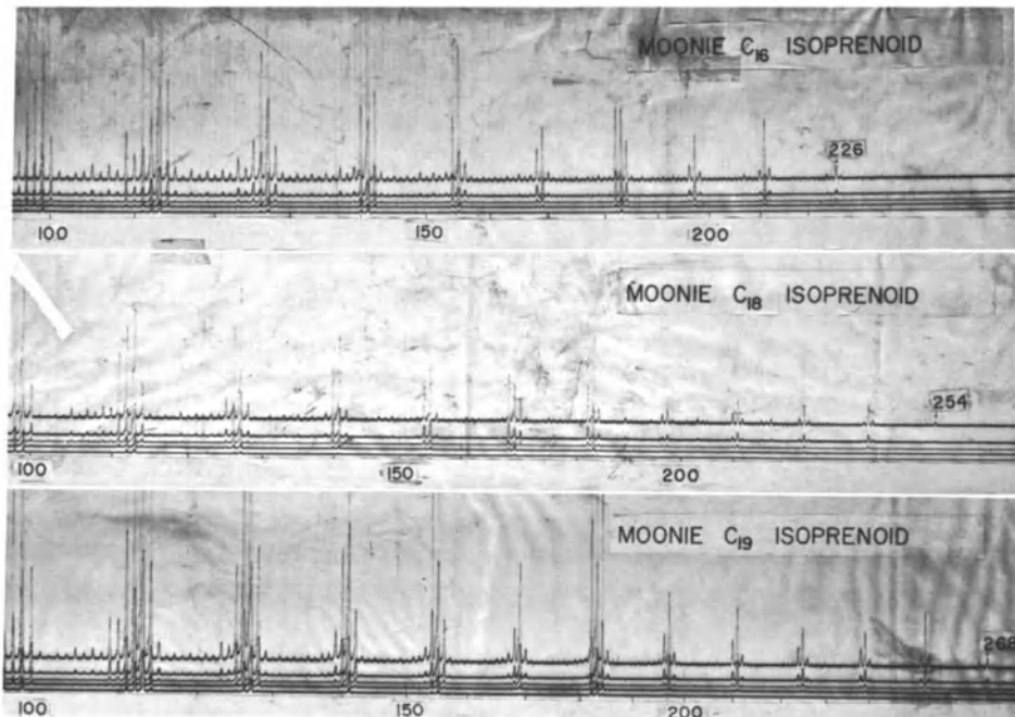
Fig. 17. Oscillograph original mass spectra of Moonie C 16 , C 18 , C 19 isoprenoid alkanes (VAN HOEVEN et al. )
